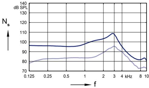
**Pression acoustique de sortie maximale ( $N_E = 90$  dB)**
