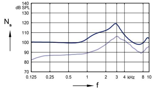
**Pression acoustique de sortie maximale ( $N_E = 90$  dB)**
